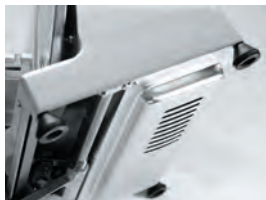
Motor refrigerado por agua protegido con una cubierta metálica
